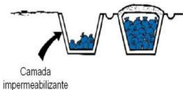
Figura 4: Imagem semelhante à célula destinada a abrigar as cinzas restantes do processo de incineração dos RSS.
